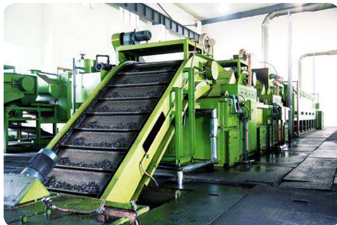
Linka dopravníků průběžné pece je určena pro tepelné zpracování válečků a pouzder, např. karbonitridování
