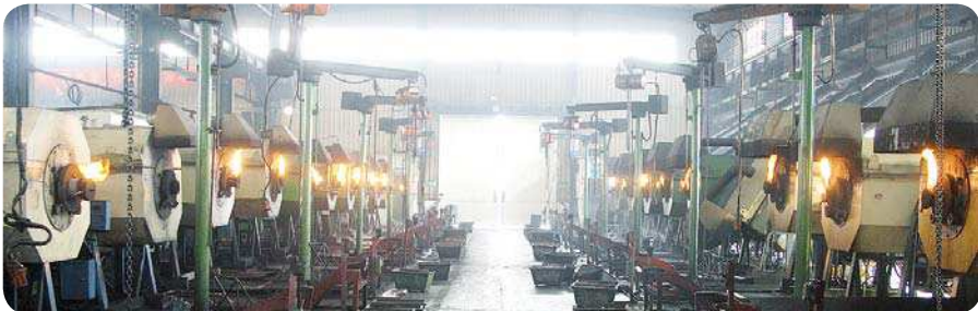
Rotační pece jsou určeny k tepelnému zpracování čepů a zajišťují jejich rovnoměrné prohřátí
