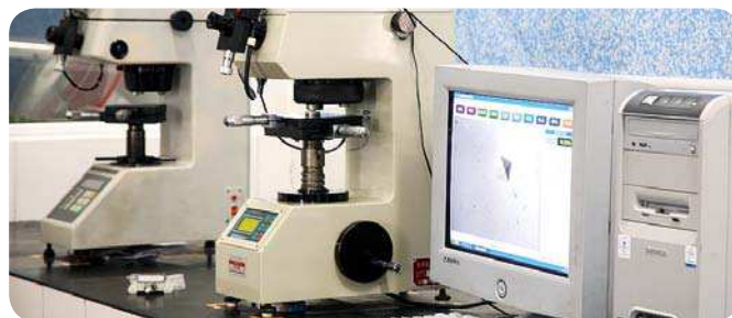
Zařízení pro testování mikrotvrdomsti, na němž jsou prováděny testy zajišťující dosažení tvrdosti odpovídající specifikaci
